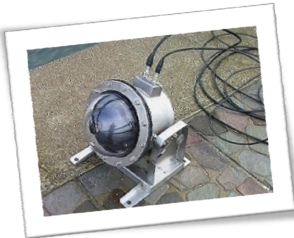
監視カメラはステンレスカバーと アクリルドームでガードされています。
